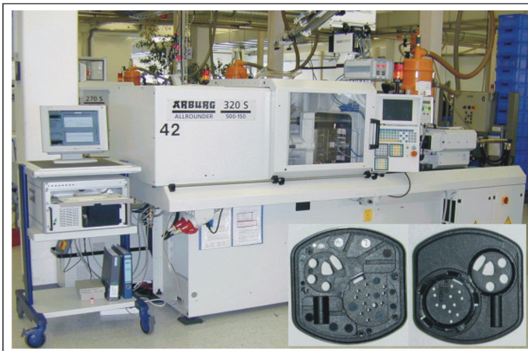
Abbildung 298: Produktion eines Präzisions-Spritzgussgehäuses für digitale Uhren (Quelle: Fa. PKT)
