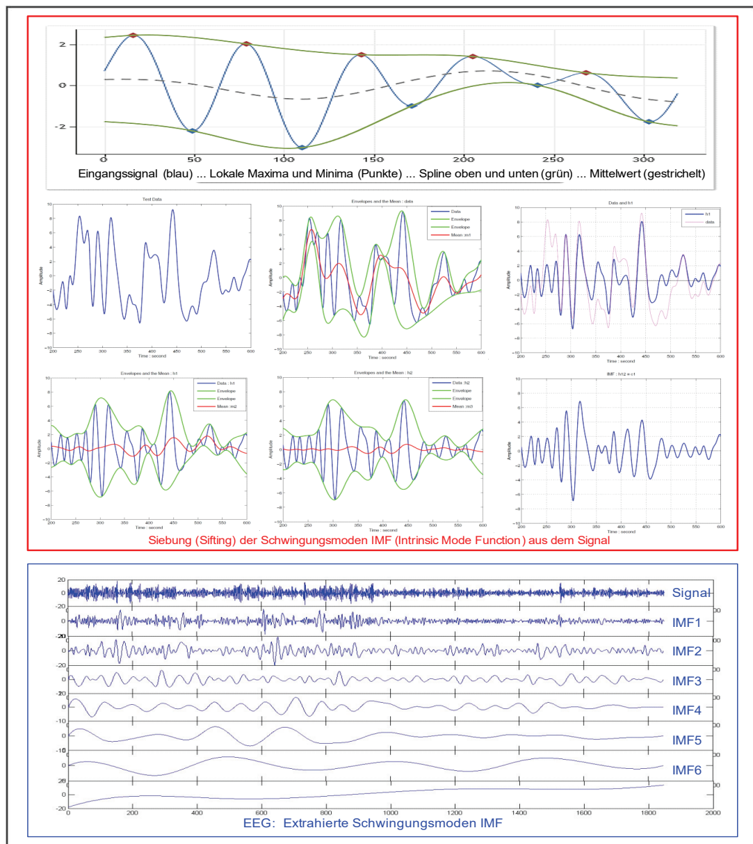
Abbildung 319: Ermittlung der Schwingungsmoden (Intrinsic Mode Function IMF) nach HUANG
